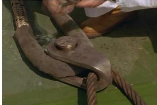
*Figure 7 : Jonction d'une amarre en fibre à un câble*
