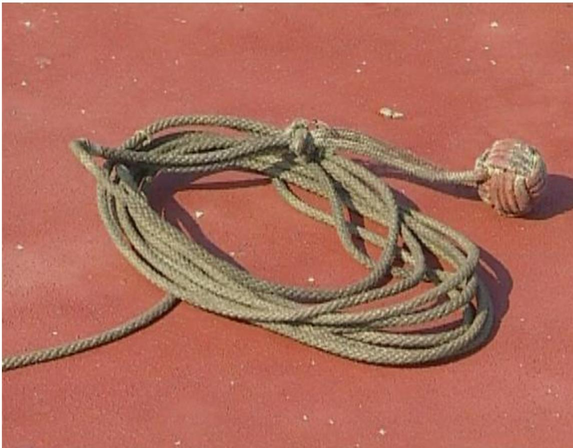
*Figure 6 : Touline (heaving line) préparée sur le pont*
