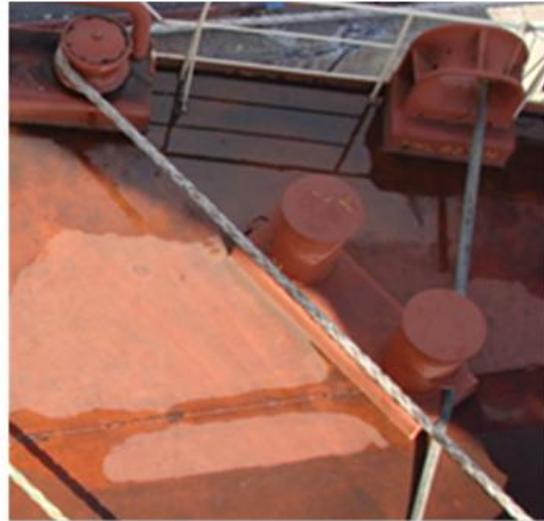
*Figure 21 : Disposition des amarres sur le pont*
