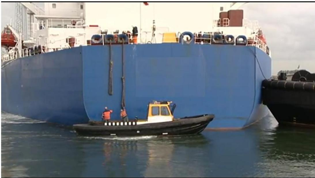
Figure 24 : Utilisation d'un bateau d'amarrage lors des opérations
